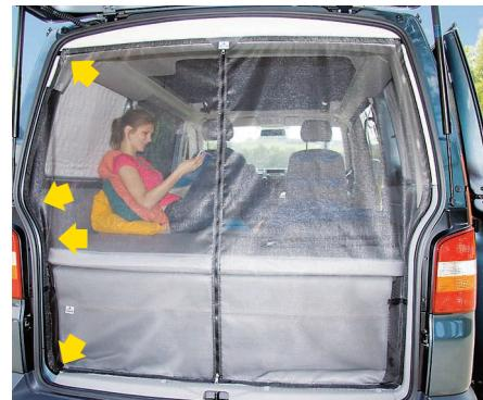
(DE) Das FLYOUT für die Heckklappen-Öffnung hat einen zusätzlichen Schieber, mit welchem das Moskitonetz auch oben geöffnet werden kann, um die Entriegelung der Heckklappe von innen bedienen zu können.
